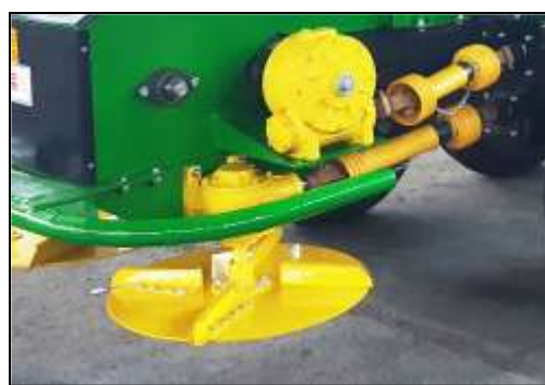
گاردان، گیربکس و دیسک پاشش چپ دستگاه
