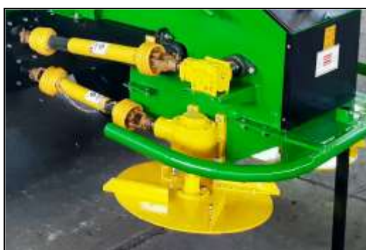
گاردان، گیربکس و دیسک پاشش راست دستگاه
